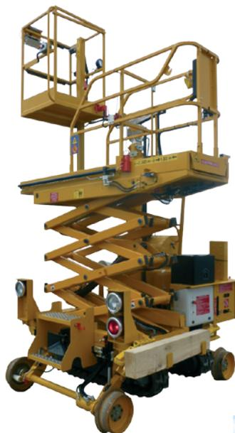
La X-LAD PLUS, engin compact et léger, a été développée afin de permettre un accès simple et facile aux réseaux caténaires.
