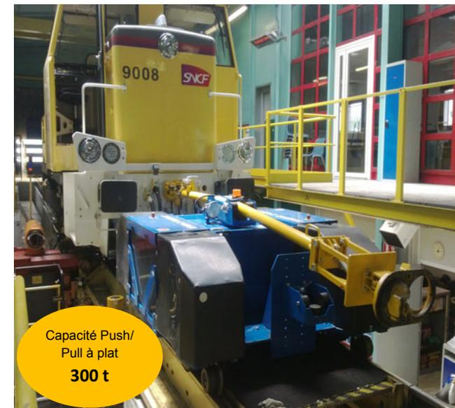
L'E-MAXI L est similaire au modèle M, mais grâce à sa masse supérieure, il possède une capacité de traction jusqu'à 300 tonnes en conditions normales d'utilisation.
